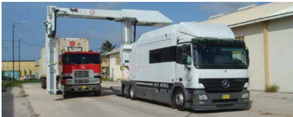
Uso de Tecnología de rayos X para el escaneo de contenedores: Imagen radiográfica no intrusiva
